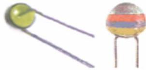
La thermistance à coefficient de température positif (CTP) sa résistance augmente quand la température augmente.
